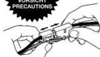
走行させない時は必ず走行用バッテリーのコネクターをはずしてください。走行用バッテリーをつないだままでおくと、車が暴走することがあります。走らせないときは、必ず走行用バッテリーのコネクターを抜いておきます。
