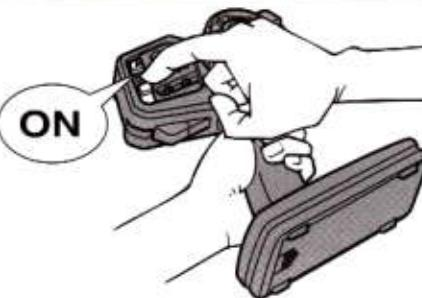
① 送信機のアンテナをのはし、スイッチをONにします。
